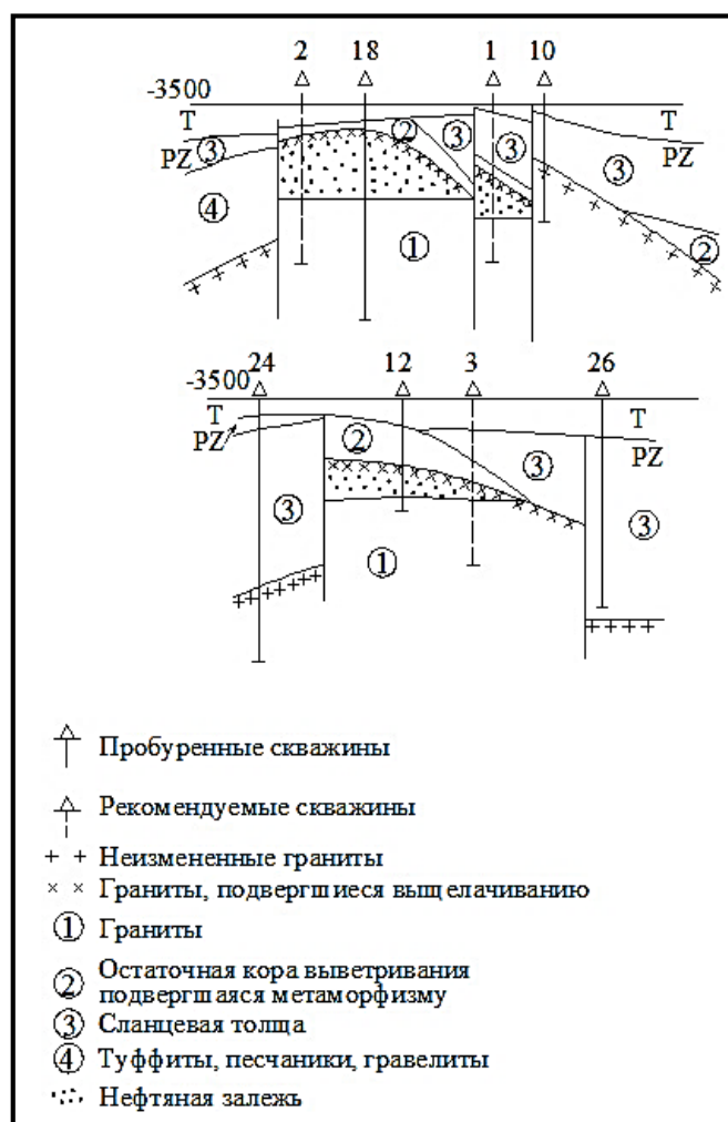
Рисунок 6 – Геологические разрезы, иллюстрирующие строение доюрской части разреза месторождения Оймаша [2]
