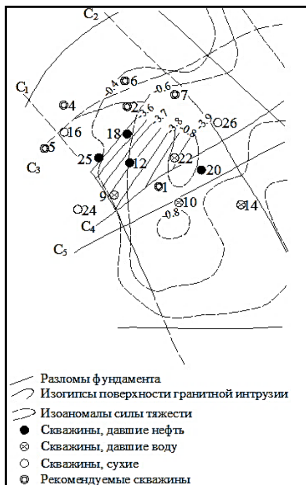
Рисунок 5 – Оймаша. Структурная схема поверхности гранитной интрузии [2]
