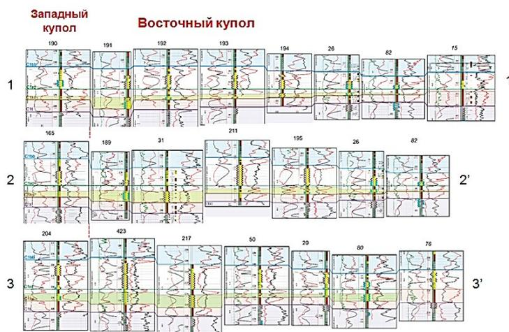
Рис. 6. Уточненная схема корреляции в пределах Западного и Восточного куполов по данным ГИС
