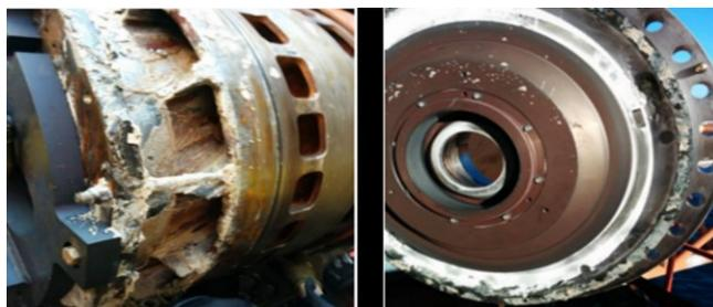
Рисунок 2 – Износ компрессорного оборудования
