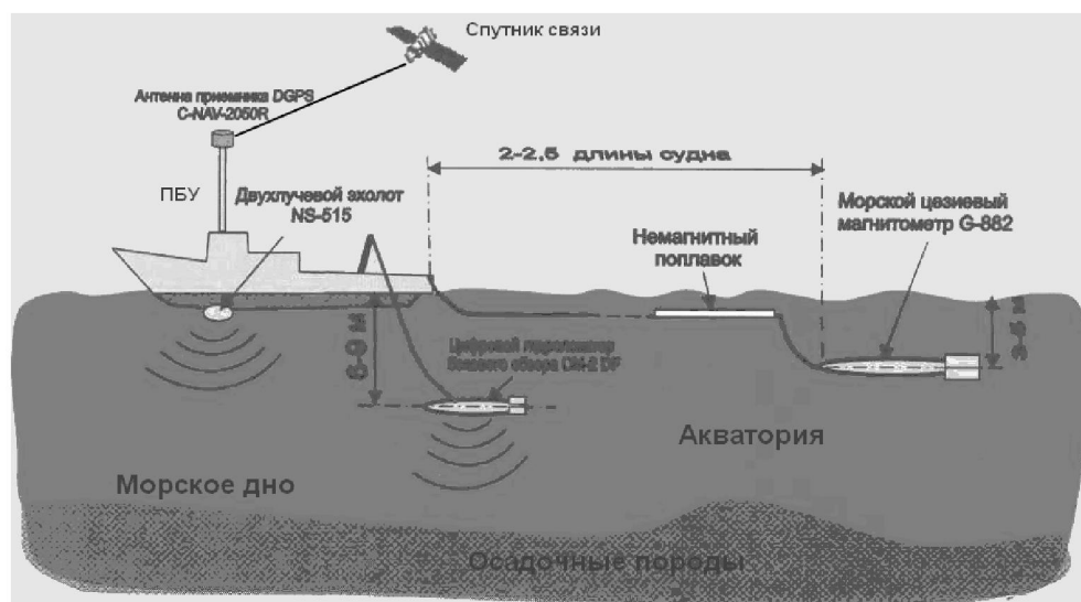
Рис. 3. Система размещения эхолотных и магнитометрических
