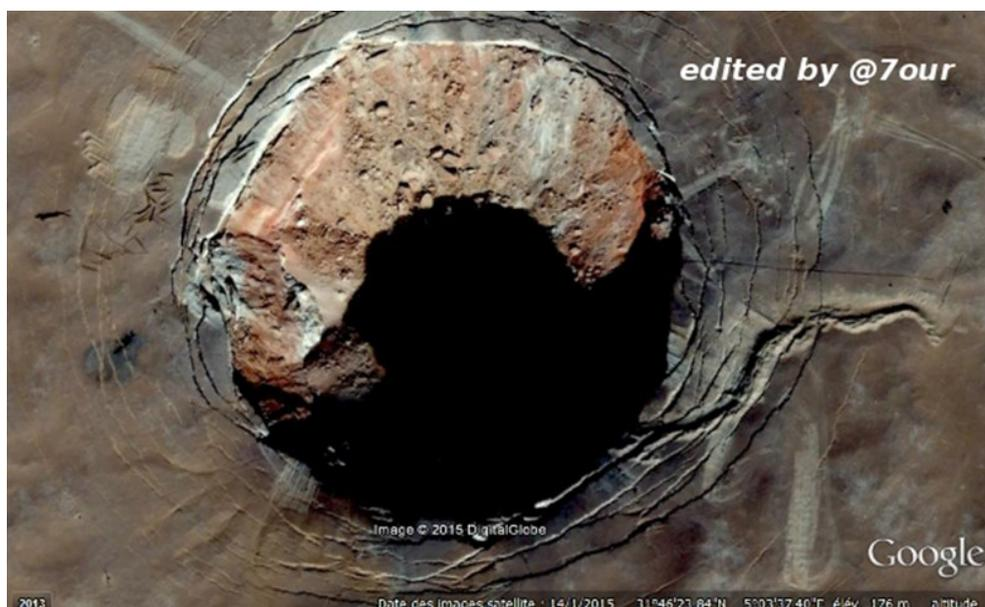
Рисунок 4 — Космический снимок (14.01.2015), показывающий кратер на месторождении Хауд Беркауи диаметром около 350 м и разломы вокруг него [6]
