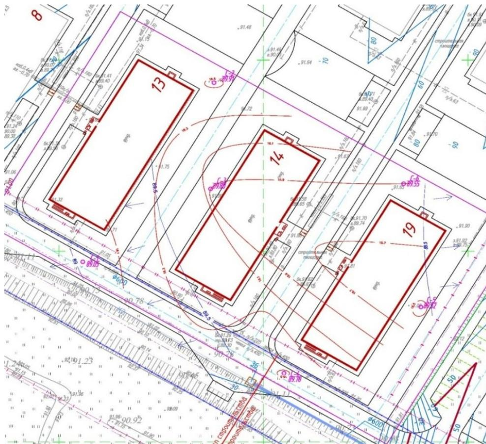
Рисунок 1 — План исследуемого объекта с прилегающими территориями:  $\odot$  — скважина;  $\frac{C-1}{89,05}$  — номер скважины / абсолютная отметка; — 0,9 — изопахиты мощности первого от поверхности водоносного горизонта; — 36,5 — гидроизогипс; ↑ направление движения грунтовых вод
