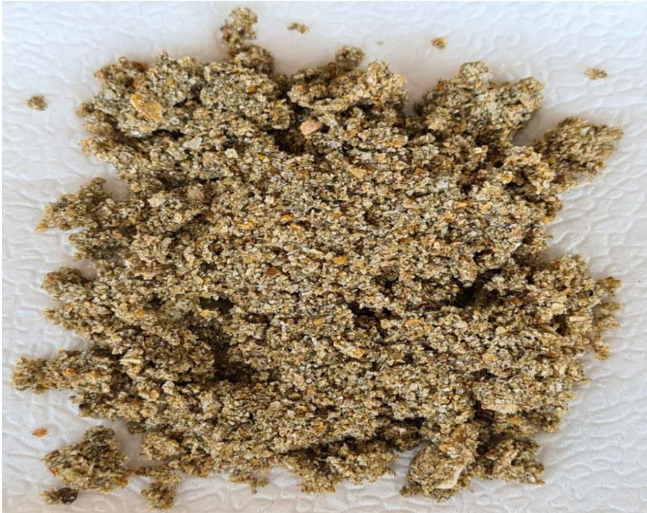
Рисунок 26 — Образец глинисто-песчаного материала вблизи берега
