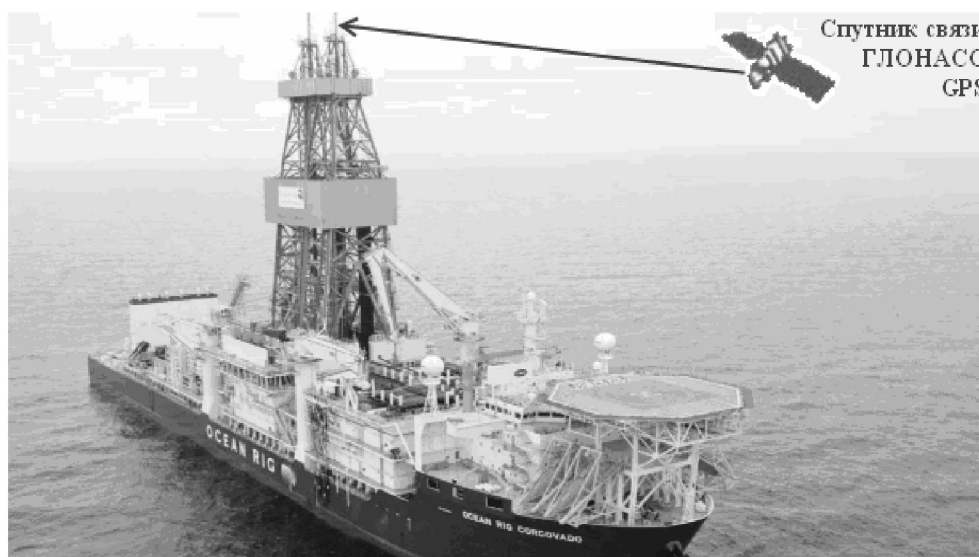
Рис. 3. Плавучая океанская буровая установка ПБУ для разведочного и эксплуатационного бурения с системой динамического позиционирования
