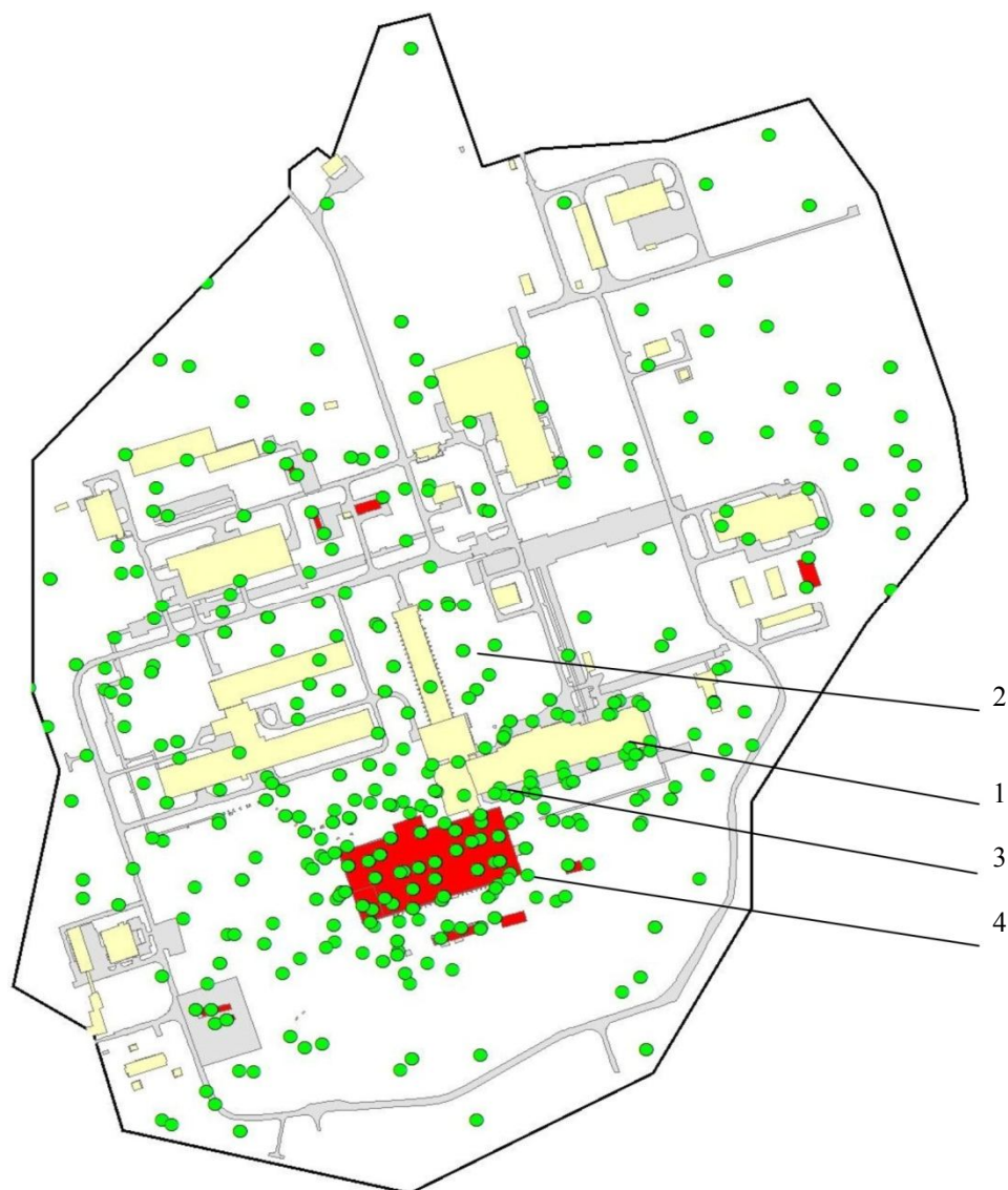
Рис. 1. Первичная визуализация распределения инженерно-геологических скважин по изысканиям прошлого десятилетия лет на территории строительной площадки г. Железногорска: 1, 2, 3, 4 – комплекс взаимодействующих промышленных зданий
