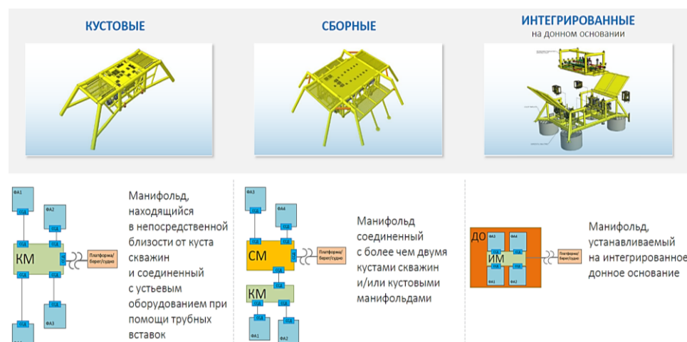
Рис. 5. Виды манифольдов подводно-добычного комплекса
