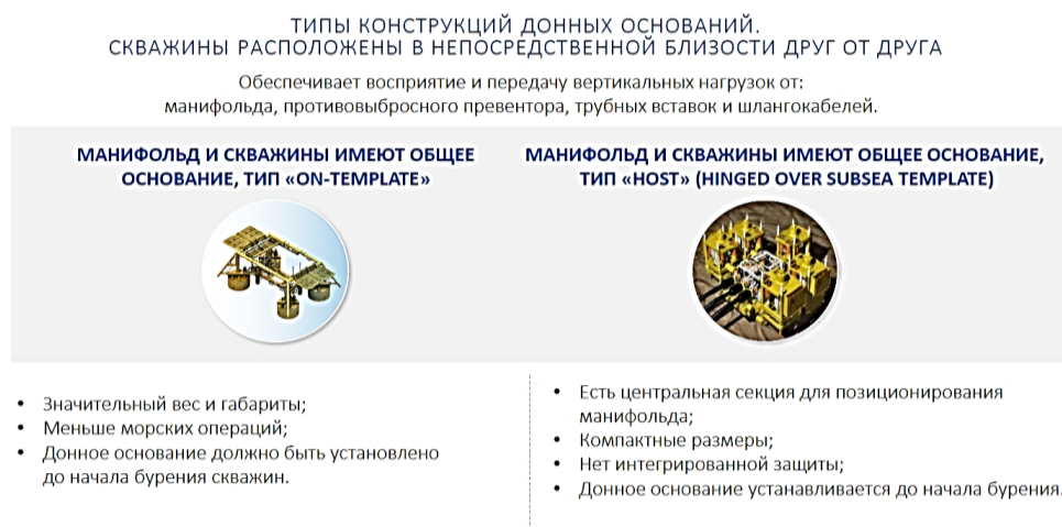
Рис. 4. Типы донных оснований для подводной добычи, где скважины расположены на небольшом расстоянии друг от друга
