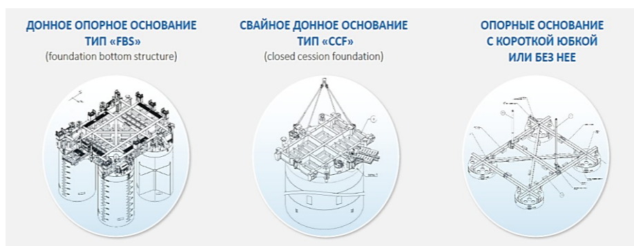
Рис. 3. Типы донных оснований для подводной добычи, где скважины расположены на значительном расстоянии друг от друга
