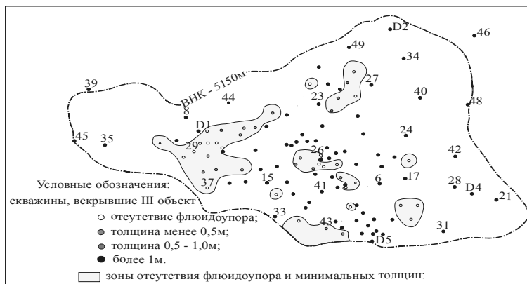
Рис. 2. Зоны отсутствия разделяющего флюидопора между II и III объектами разработки
