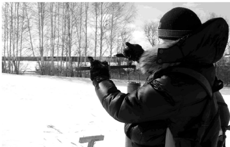
Рис. 2. Отбор образцов снега с помощью снегомера
