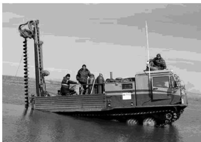
Рис. 1. Скважинный (погружной) источник на базе вездехода ТМ-130
