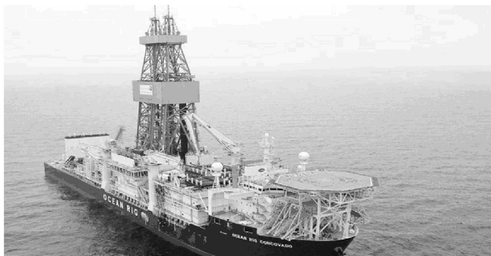
Рис. 3. Плавающая буровая установка ПБУ для разведочного эксплуатационного бурения с системой динамического позиционирования
