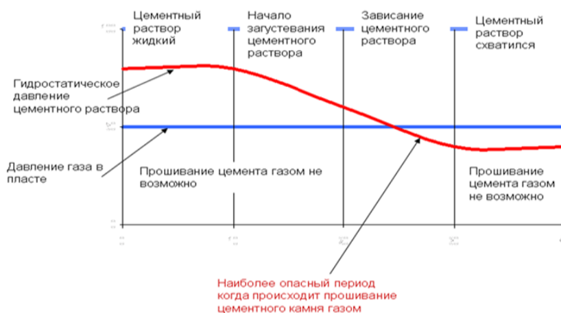
Рисунок 3 – График образования цементного камня
